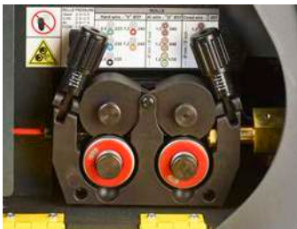
Professioneller Doppelspur-Vorschubmechanismus über 4 DV-Rollen
