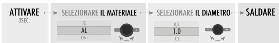
**MAXIQ** ti offre il controllo digitale di tutti i parametri direttamente sul trainafile MF4 (raffreddati ad aria) e MF4W (raffreddati ad acqua). **MAXIQ**, in combinazione con MF4/MF4W, funziona perfettamente in qualsiasi situazione.
