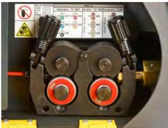
Mécanisme professionnel d'alimentation à double rainure avec 4 galets
