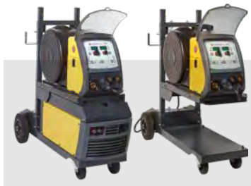
Carrello porta bombola CT 401 con raffreddamento ad acqua e cassetto (solo per CONVEX MOBILE 3PH)
