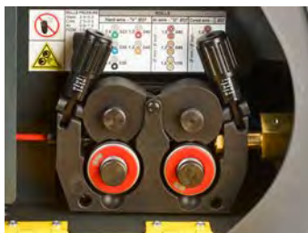
Meccanismo di alimentazione professionale a doppia cava con 4 rulli
