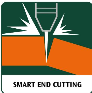
Innovative Funktion, der am Ende des Schnittes eine geregelte und optimal abgestimmte Stromabsenkung realisiert.
