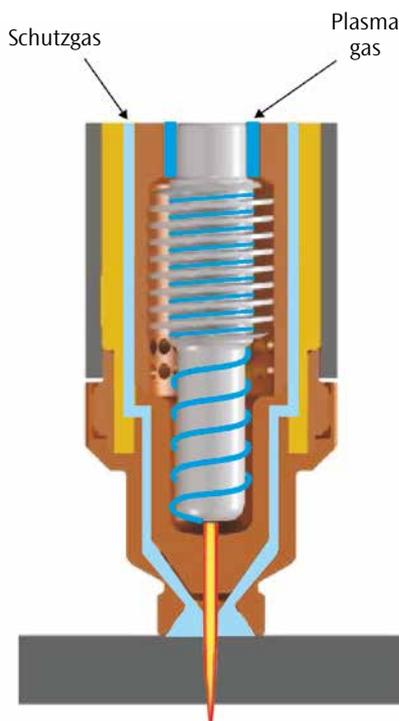
Die neuen SK Schneidbrenner mit **High Performance Cutting Technologie** erhöhen die Energiedichte im Lichtbogen und verringern die Schnittbreite. Daraus resultiert ein schmaler und stark richtungsstabiler Schnitt, der sich durch saubere und eckige Kanten, geringe Schlackenanhaftung und minimale Wärmeeinflusszone auszeichnet.
