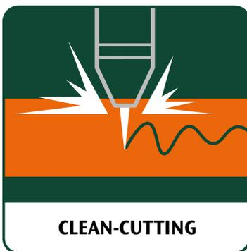
Proceso capaz de producir un ancho de corte muy estrecho para mejorar la calidad de corte de los metales delgados con detalles o formas complejas. Con este proceso es posible reemplazar tecnologías más costosas como el láser y el waterjet. Es posible obtener cortes precisos incluso con plasma de aire usando los consumibles Clean-Cut disponibles para las antorchas SK125 para corte manual y para aquellos SKM125 montados en sistemas automatizados.
