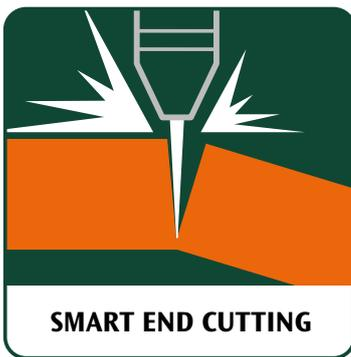
Función innovadora que permite, al final del corte, un declive gradual y sinérgico de la corriente hasta un valor óptimo.
