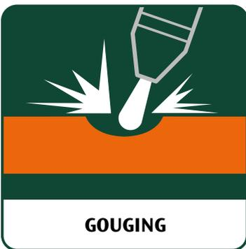
El ranurado por plasma es un método rápido y económico para la eliminación del metal. El ranurado por plasma es adecuado para todo tipo de metales conductivos, incluidos el acero al carbono, el acero inoxidable, el aluminio y el cobre. En comparación con el ranurado tradicional por electrodos de carbono, el ranurado por plasma otorga las siguientes ventajas:
