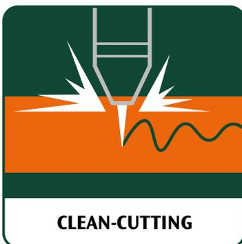
Processo in grado di produrre una larghezza del taglio molto sottile per migliorare la qualità di taglio dei metalli sottili (fino a 2mm) che presentano particolari dettagliati o forme complesse.
