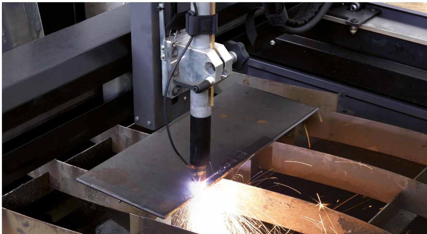
I modelli **SHARK 46-M**, **SHARK 55-M**, **SHARK 75-M**, **SHARK 105-M**, **SHARK 125-M** e **SHARK 155-M**, forniti con le torce per automazione SKM, sono adatti per essere impiegati in applicazione di taglio automatizzato.
