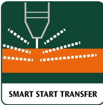
Innovativo circuito elettronico che permette un ottimale e graduale trasferimento da arco pilota ad arco di taglio all'innesco dell'arco di taglio.
