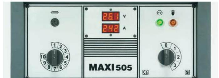
**BEDIENFELD** Digitales Amperemeter/Voltmeter mit Funktion zum Halten der letzten Schweißparameter (optional)
