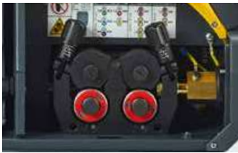
Professioneller Doppelspur-Vorschubmechanismus über 4 DV-Rollen
