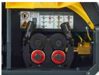
Professioneller Doppelspur-Vorschubmechanismus über 4 DV-Rollen
