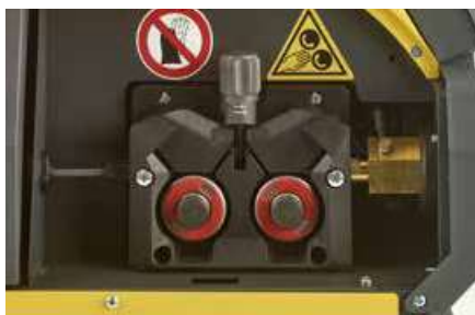
Professioneller Doppelspur-Vorschubmechanismus über 4 DV-Rollen
