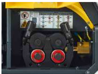
Mecanismo de alimentación profesional de doble ranura con 4 rodillos
