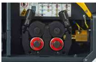
Mecanismo de alimentación profesional de doble ranura con 4 rodillos
