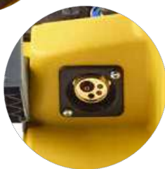
ATTACCO TORCIA INCLINATO
