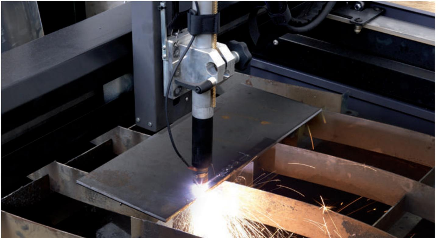
Die Modelle **SHARK 46-M**, **SHARK 55-M**, **SHARK 75-M**, **SHARK 105-M**, **SHARK 125-M** und **SHARK 155-M** mit Maschinenbrenner SKM, sind für den mechanisierten Schneideinsatz geeignet.
